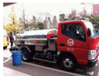
（新しく配備される給水車） タンク最大容量 1,900ℓ
